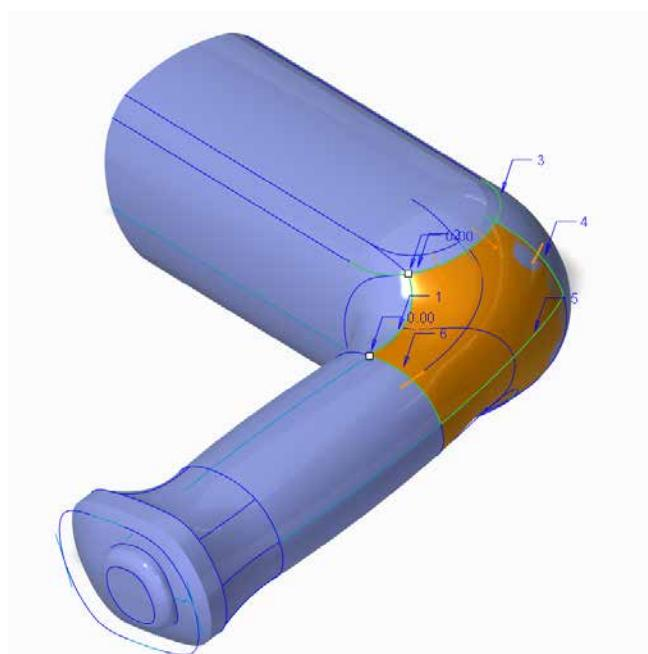
Усовершенствованные инструменты построения поверхностей, используемые в Creo ISDX, позволяют создавать высококачественные поверхности при наличии более чем 4 границ.
