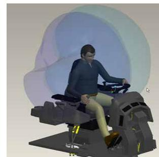
Модуль Creo Manikin Extension позволяет быстро определять поле обзора и зону досягаемости.
