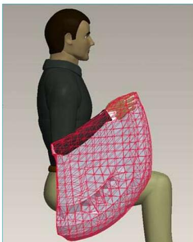
Оболочка области движений и функция замены позволяют конструктору эффективно оценить требования к расположению элементов и свободному пространству при активации элемента управления.
