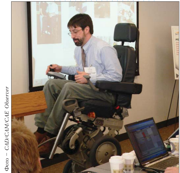
Разработанное в Pro/E компанией Deka R&D инвалидное кресло нового поколения с уникальными возможностями преодоления препятствий
