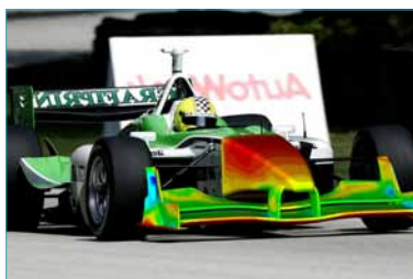
Кузов болида 2007 ChampCar фирмы Conquest®. Этот файл был создан в модуле Pro/ENGINEER Interactive Surface Design Extension (ISDX) и использован для оптимизации аэродинамики CFD в собственном файле Pro/ENGINEER.
