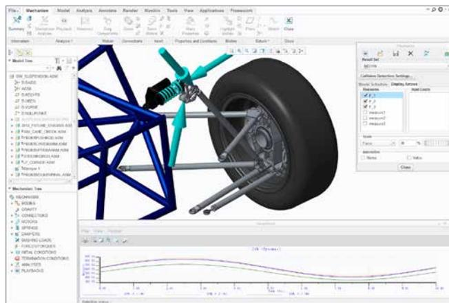
Модуль Mechanism Design позволяет создавать механические соединения и выполнять симуляцию движения подвижных сборок.
