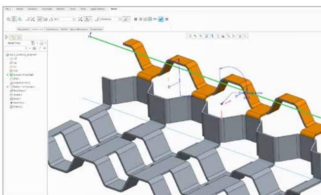
Создание геометрии листовых деталей с помощью функций автоматического подреза сгибов, создания разрывов, изгиба копланарных граней и многих других.
