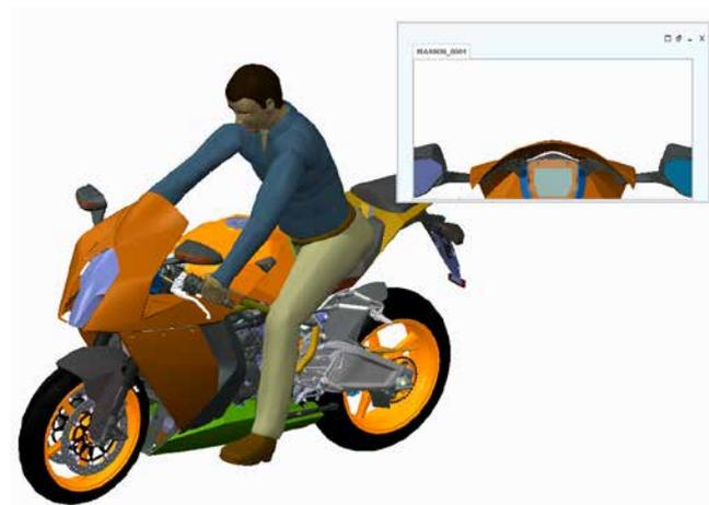
Модуль Creo Manikin Extension позволяет быстро помещать манекены в модели 3D CAD для визуализации и оптимизации взаимодействия человека и изделия.
