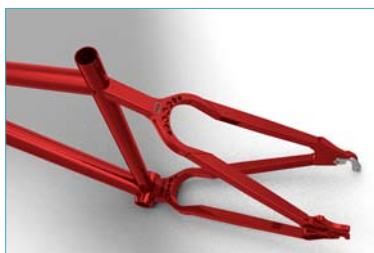
Рама с одним передним амортизатором для горного велосипеда Арех, разработанная в Pro/ENGINEER.
