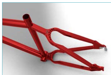
Рама с одним передним амортизатором для горного велосипеда Аренс, разработанная в Pro/ENGINEER.
