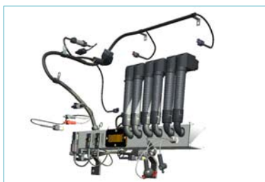
Рендеринг «полужесткого» жгута для рядного шестицилиндрового дизельного судового двигателя. Пакет Pro/ENGINEER оказался очень полезен Крису Бридену (Chris Breeden) при проектировании подобных (зачастую очень крупных) сборок жгутов.
