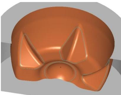
Карандашная обработка обычно используется для чистовой обработки углов, которые не были обработаны предыдущим инструментом. Эта стратегия идеально подходит для обработки углов, где радиус поверхности совпадает с радиусом режущей части. Создается один единственный проход. По умолчанию траектория инструмента поддерживает встречное фрезерование и может использоваться в сочетании с углами контакта.
