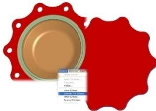
Иногда при обработке пресс-форм необходимо удалить отверстия и обрезать элементы поверхностей, чтобы более эффективно изготовить деталь. **NCG CAM** обладает функциональными возможностями, которые позволяют исключить отверстия даже на 3D поверхностях двойной кривизны или полностью удалить внутренние кромки поверхности , как показано слева.
