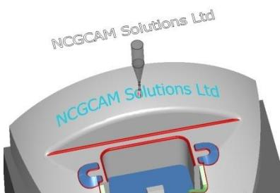
Обработка Вдоль Границы, создает обработку вдоль открытого или замкнутого профиля границы. Можно использовать отрицательный припуск для обработки поверхности и углы контакта.
