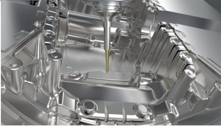
Единственный недостаток обработки реальных поверхностей состоит в том, что время расчета программ с контролем зарезов в этом случае увеличивается. Для поверхностей, требующих высокого качества обработки целесообразно использовать эту возможность, что позволяет значительно сократить время на последующие доводочные операции.
