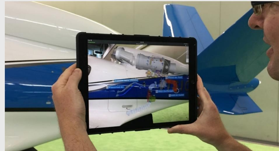
Дополненная реальность используется для визуализации крупных сборок в определенной плоскости.
